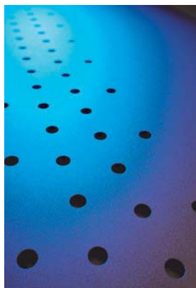
Stahlblech gelasert und gereinigt
